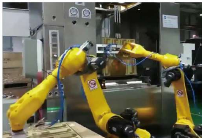
Роботизированная загрузочно-разгрузочная ячейка для распыления припоя
