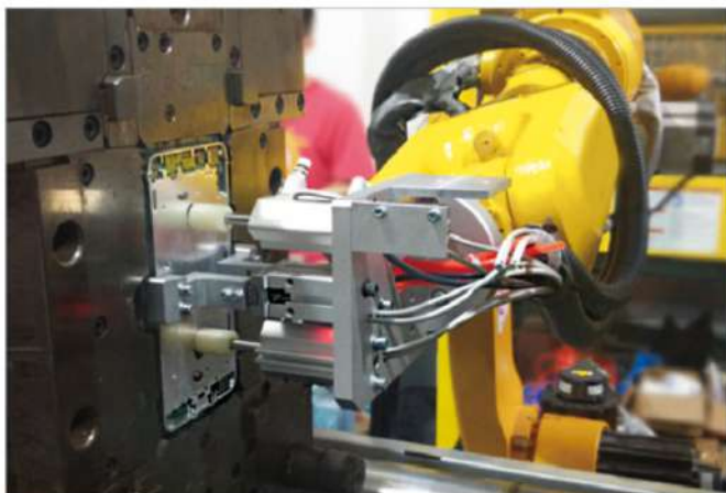
Роботизированная загрузочно-разгрузочная ячейка для машины для литья под давлением
