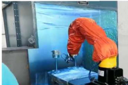
Нанесение краски на водной основе для покрытия двигателя
